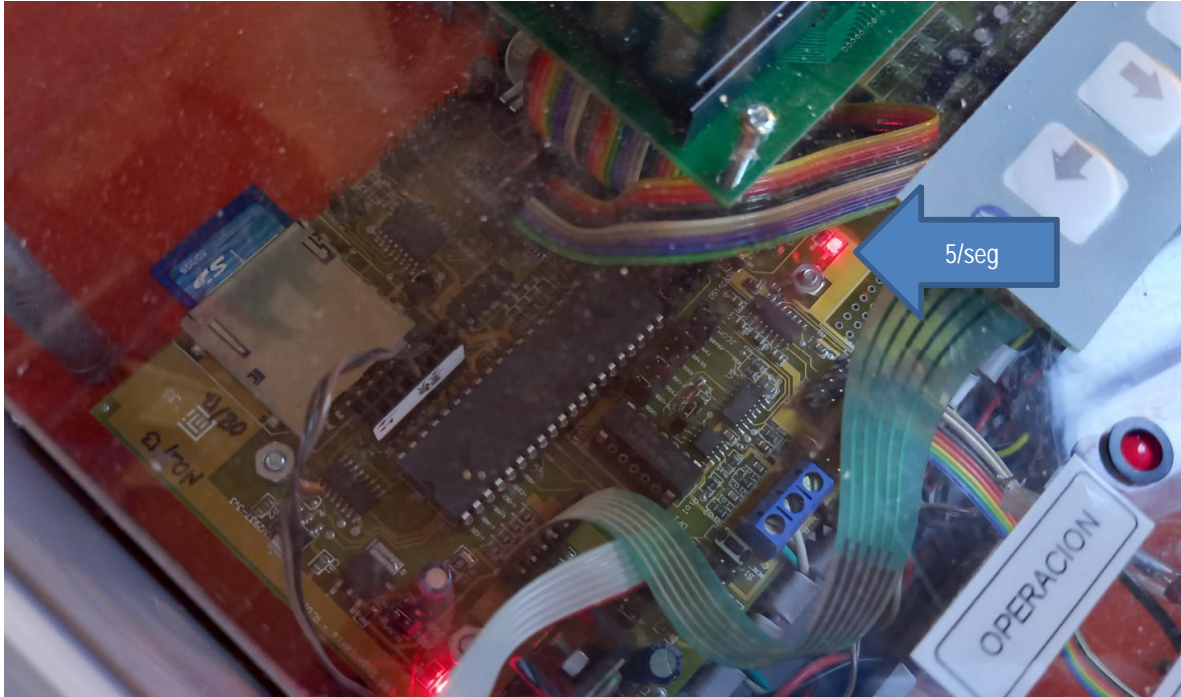
Figura 2 reencendido con bootloader Optiboot cargado, a la espera de nuevo Firmware vía puerto serie
